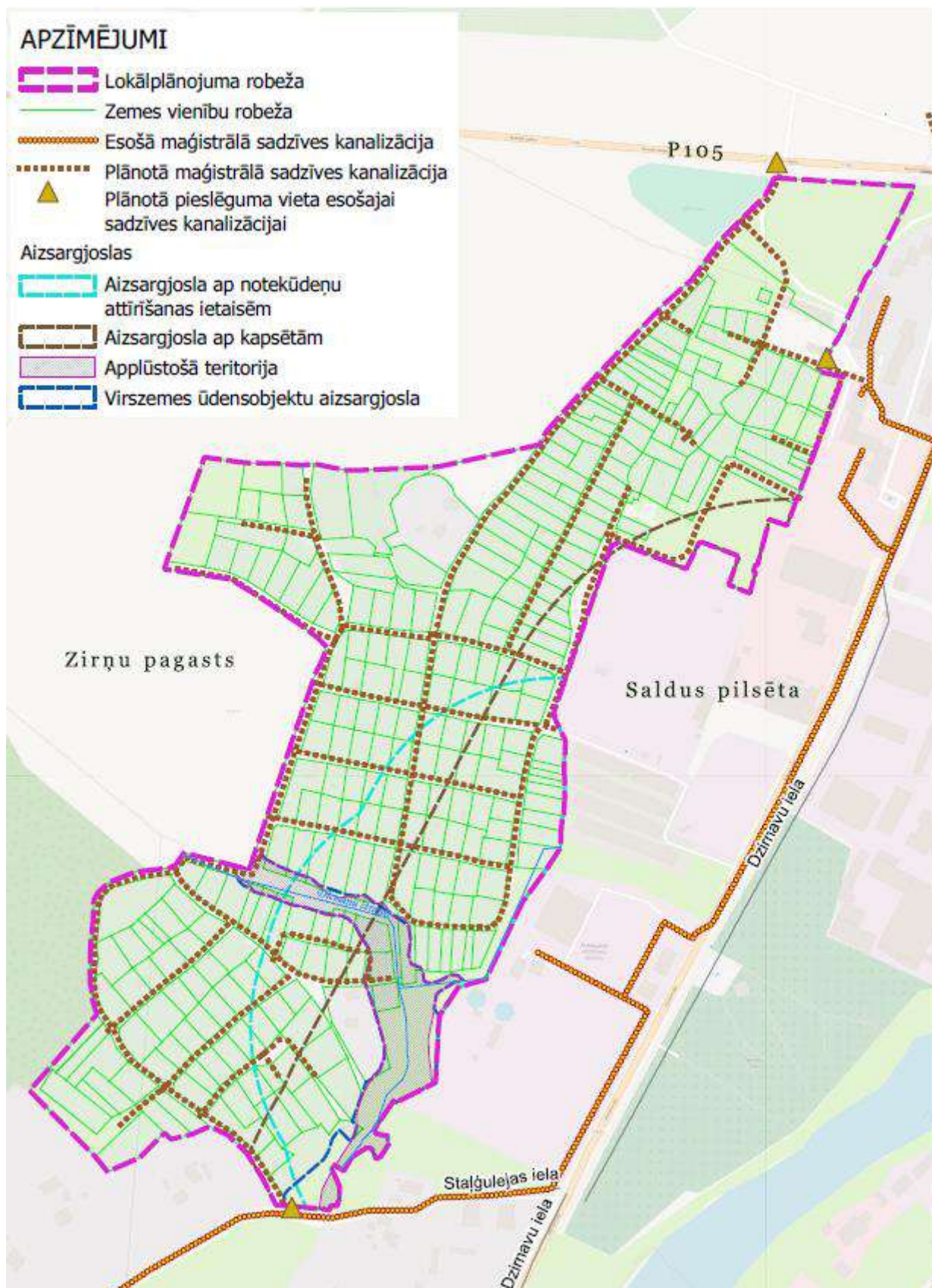
42.attēls. Plānotās sadzīves kanalizācijas shēma
