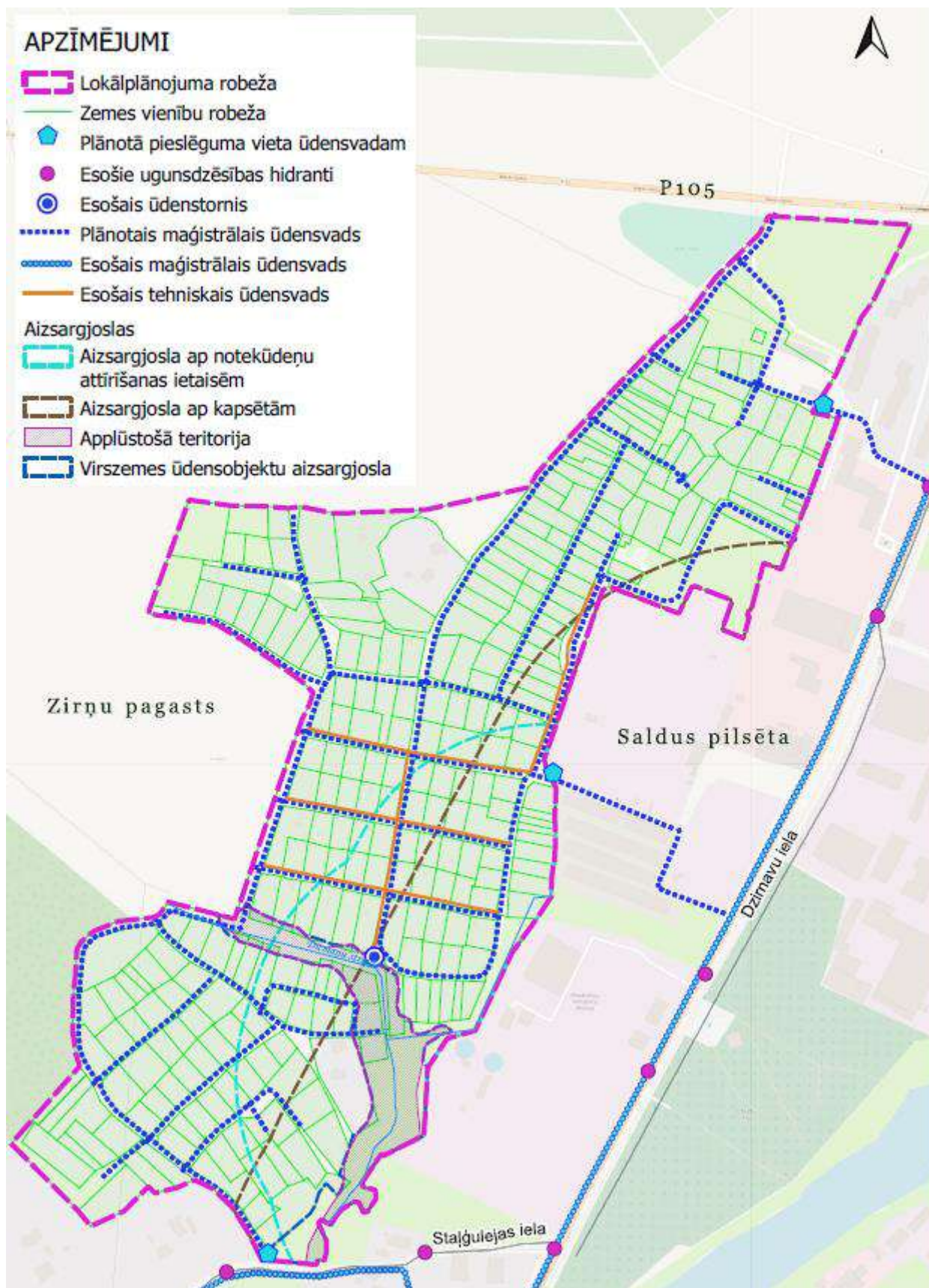
41.attēls. Plānotās ūdensapgādes shēma
